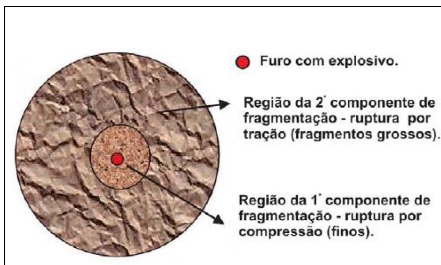
Figura 17 – Componentes do furo de acordo com o Modelo de Fragmentação TCM
